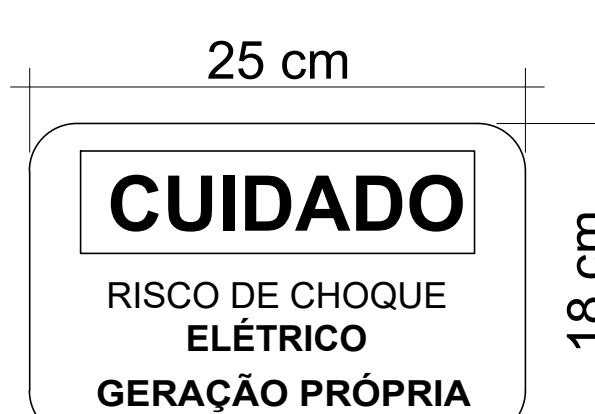
DETALHE DA PLACA DE AVISO DE GERAÇÃO PRÓPRIA
